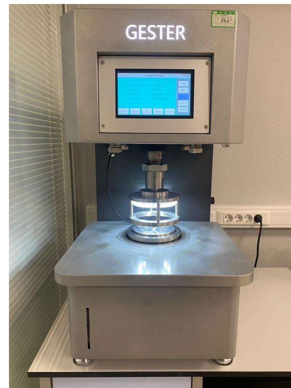
Установка для измерения водонепроницаемости, Завод Лоджикруф, г. Рязань
