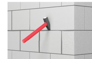
Подготовьте стены перед утеплением. Удалите осипающуюся штукатурку, срежьте выступающие части (гвозди, арматура), выровняйте поверхность штукатурным составом. Перепад на один этаж не должен превышать 5 мм.
