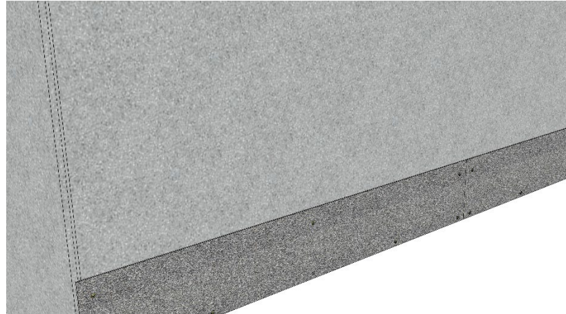
Стартовая полоса (8 саморезов)
