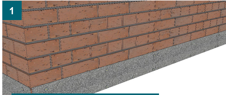
Монтаж стартовой полосы (8 гвоздей на плитку)
