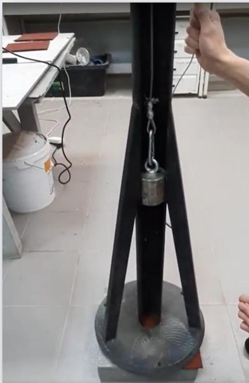
Гидроизоляционная мембрана остается неповрежденной:
