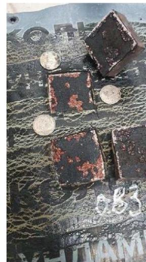
Адгезия к бетону в лаборатории ТЕХНОНИКОЛЬ
